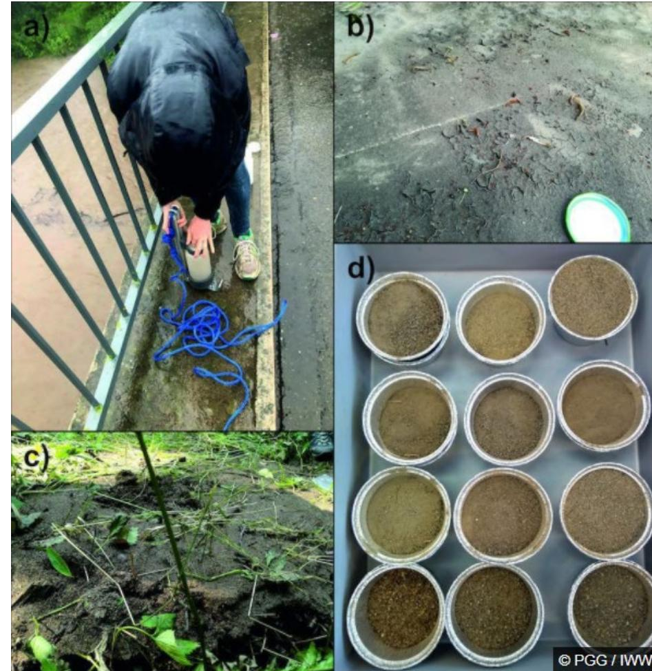
Abbildung 2: a) Probennahme suspendierter Sedimente, b) beprobtes Hochwassersediment auf Parkplatz, c) beprobtes Hochwassersediment auf einer Flussaue der Rur, d) getrocknete Sedimentproben im physisch-geographischen Labor des PGG
